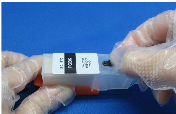
② 注入口にボトルのノズルを差込み、インクの注入を始めます。
