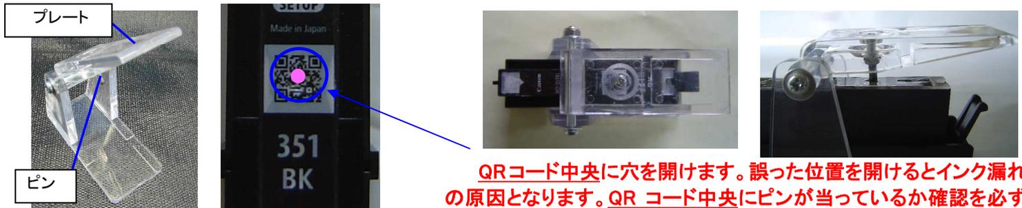
**QRコード中央に穴を開けます。誤った位置を開けるとインク漏れの原因となります。QRコード中央にピンが当たっているか確認を必ずしてください。**
