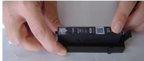
③ボール栓落し工具にインクタンクを装着した詰め替えホルダーを取り付けます。詰め替えホルダーとボール栓落し工具のそれぞれのガイド装着部に合わせます。
