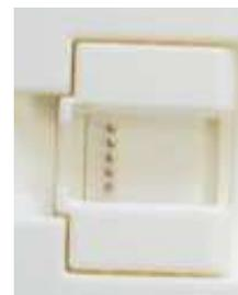
②リセットピンとカートリッジの IC チップが接触する様に乗せます。リセッターランプが赤点灯から緑点灯になった時点でリセット完了です。インク詰め替え作業に進みます。(別紙参照)
