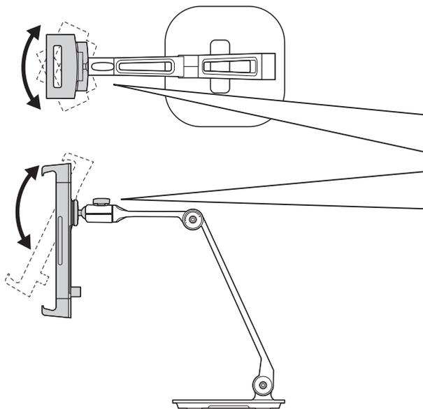
ホルダーの動きが軽すぎたり、重すぎる場合はホルダー調節ネジを回して調節します。
