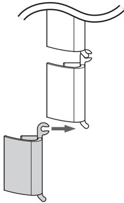
昇降デスクを使用の場合は、立って使用する高さに合わせて本製品の長さを調整してください。天板の昇降に合わせて、ケーブルカバーが屈伸します。
