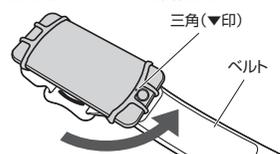
②スマートフォンの下側を持ち上げ、下図の矢印の方向にスライドさせて取外します。
