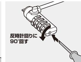
③お好みの番号にした後、側面のボタンを反時計回りに90°回して元に戻せば設定完了です。
