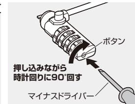
②錠側面にあるボタンを、マイナスドライバーなどで押し込みながら時計回りに90°回す
