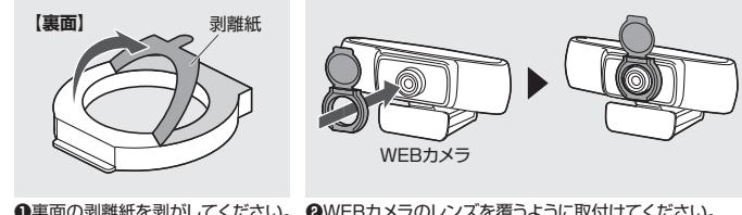
①裏面の剥離紙を剥がしてください。②WEBカメラのレンズを覆うように取付けてください。
