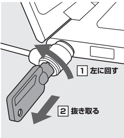
④ 鍵を左回りに90°回転して抜き取ると、本体がスロットにロックされます。
