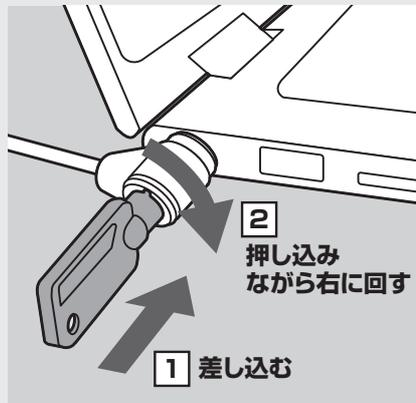
① 鍵を錠の穴に合わせて差し込み、押し込みながら右回りに回転すれば開錠されます。
