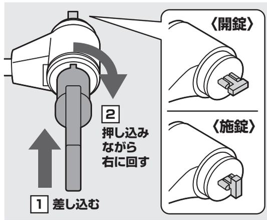
② 鍵を錠の穴に合わせて差し込み、押し込みながら右回りに90°回転して、先端部分を「開錠」にしてください。
