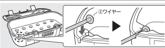
②ワイヤーの先端をセキュリティボックスに取付けてください。その後、「施錠方法」の手順で施錠してください。
