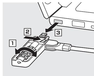
ダイヤルを開錠番号に合わせ、レバーを矢印の方向にスライドさせて「0」に合わせ、引き抜きます。
