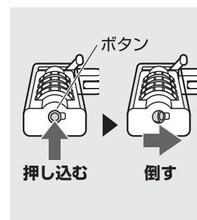
②本体側面にあるボタンをペン先などで押し込み、矢印の方向に倒します。
