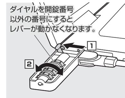
④レバーを矢印の方向にスライドさせて「0」に合わせ、ダイヤルを回せば取付け完了です。
