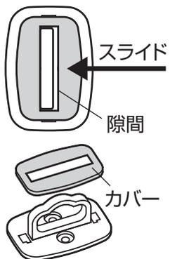
①隙間がある方からカバーをスライドして取外します。
