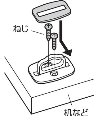
②取付け部品本体をねじ止めし、カバーを取付けます。
