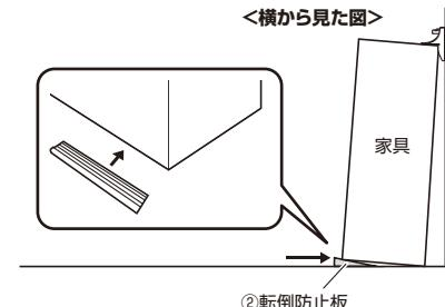
(4)各ブロックの剥離紙を上に引き抜き、壁によく接着されるよう家具の上部を2、3回押してください。
