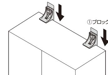
(3)家具を傾けて、それぞれ床との間に転倒防止板を挿入します。
