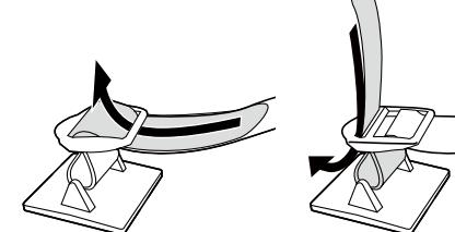
②ドライバーを接着パッド付きフックに掛け、ゆっくり水平に回転させてテレビ背面、テレビ台から剥がします。
