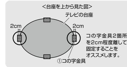
④テレビを設置場所にゆっくりと置いた後、強く押し付けて固定します。
