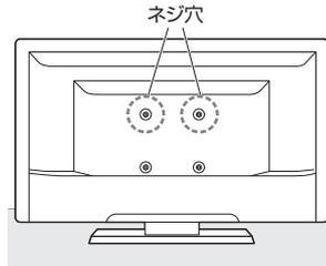
テレビ上側ネジ穴径に合うネジを、付属ネジの4サイズから選んでください。
