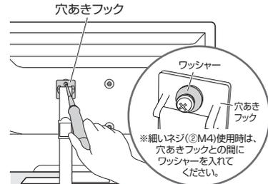
穴あきフックをテレビ背面に付属ネジでプラスドライバーを使って固定します。もう片側のネジ穴にもフックを固定してください。
