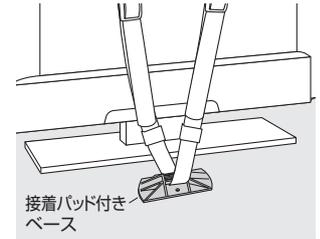
接着パッド付きベース裏側の剥離シートを剥かし、テレビ台に強く押し付けて接着固定してください。
