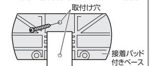
テレビ台に接着固定できない場合は、壁に接着固定して使うことができます。弱い壁の場合は、付属のタッピングネジ(⑦)2本を併用してベースを固定してください。
