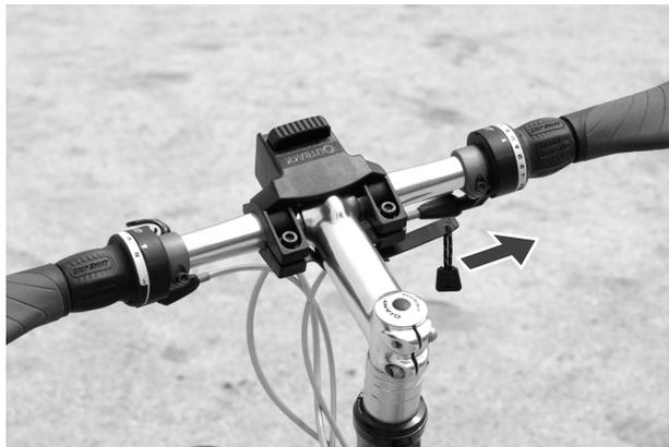
ボルトにワッシャを通して締め付けます。
