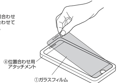
6. ガラスフィルムに残った空気を、クリーニングクロスでフチの方へ押し出します。
