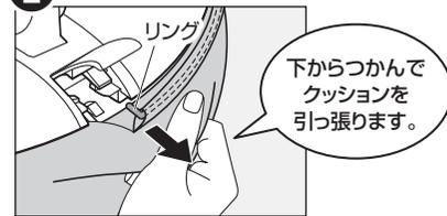
**3** もう片方のリングの端も外し、クッションを取外します。
