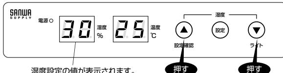
(3) 設定ボタンを押すか、約5秒間操作をせずに待つと湿度表示が点滅から点灯に変わり、設定が保存されます。
