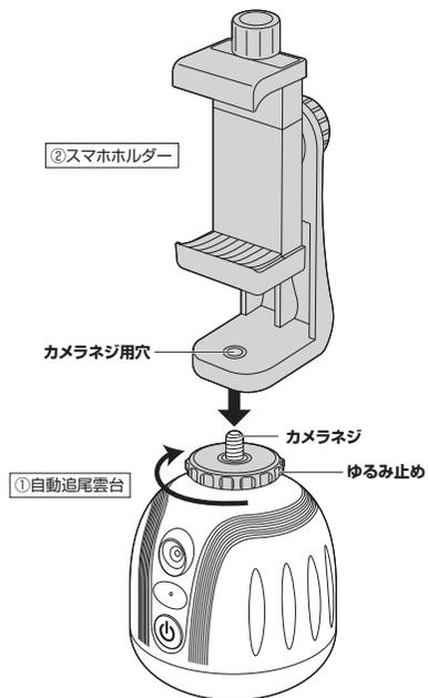
※スマホを縦置きして使用する場合は、角度調節ツマミを回し、ホルダーを横向きに回転させておいてください。
