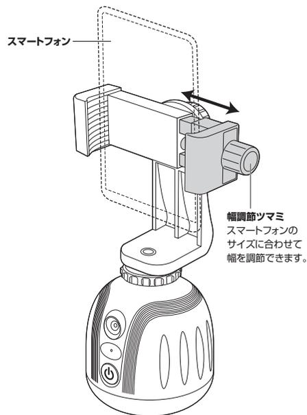
2.カメラが正面を向くよう、ゆるみ止めを矢印の向きに回して調節します。
