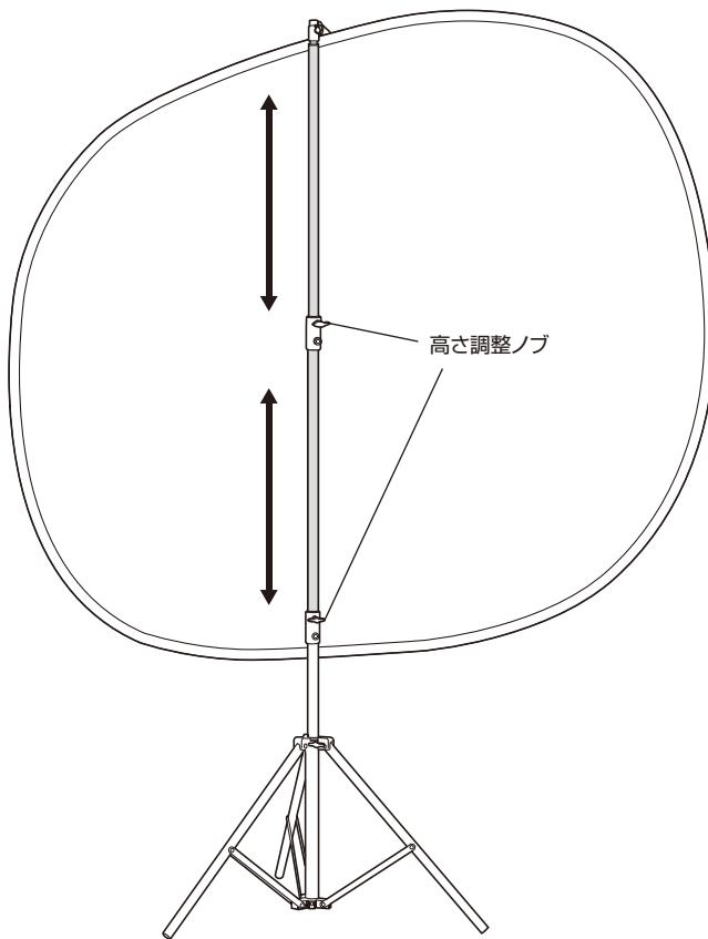
**△** 高さを調整後は高さ調節ノブをしっかりと締め付けて固定してください。
