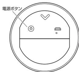
2 電源ボタンを押すと、暖白→白→暖色の順に色が切替ります。暖色の状態で電源ボタンを押すと消灯します。ライトが点灯した状態で電源ボタンを長押しすると、調光します。
