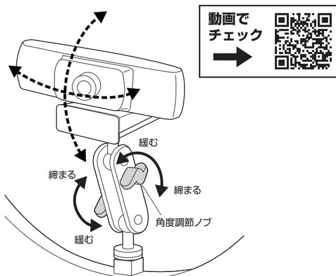
※両側の角度調節ノブを緩めて位置を調節した後、再度締め付けて固定します。
