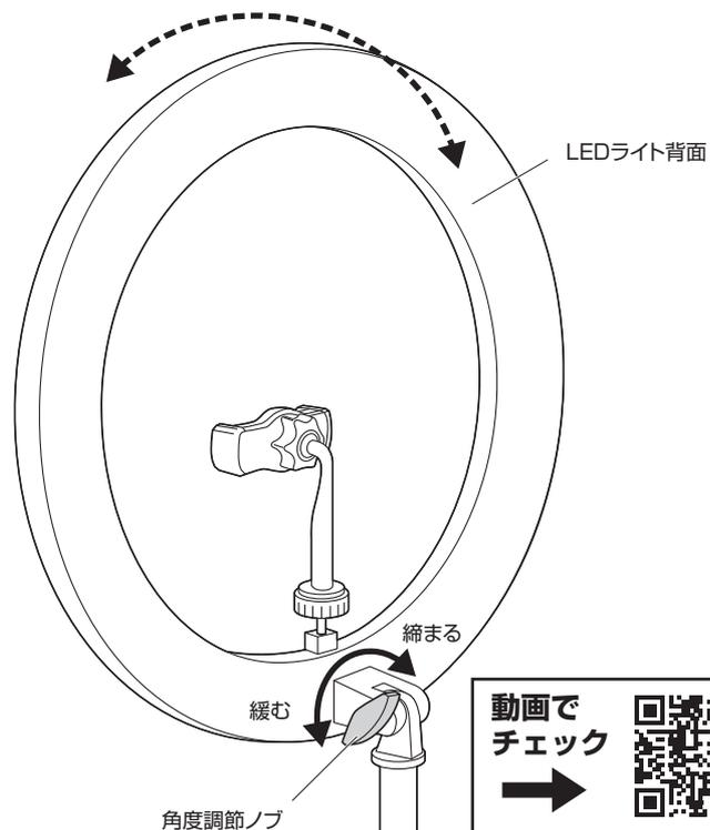
※調節後は、角度調節ノブをしっかり締め付けて固定してください。
