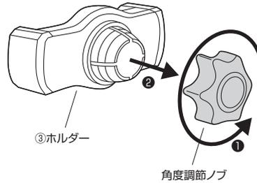
(2) ホルダー用ジョイントに角度調節ノブとホルダーを取付けます。
