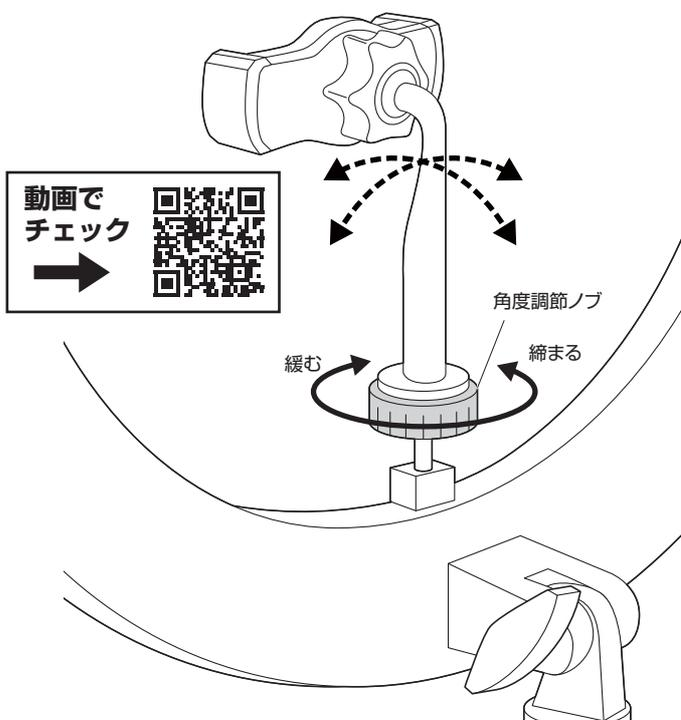
※調節後は、角度調節ノブをしっかり締め付けて固定してください。
