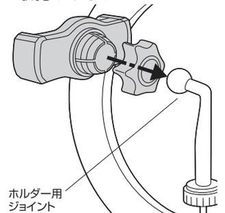
(3) 角度調節ノブを締め付けてホルダーを固定します。
