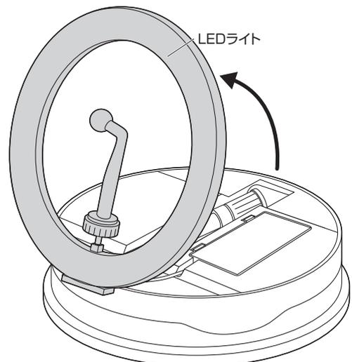
(2) 本体のケーブル収納部を開けてケーブルを取出します。
