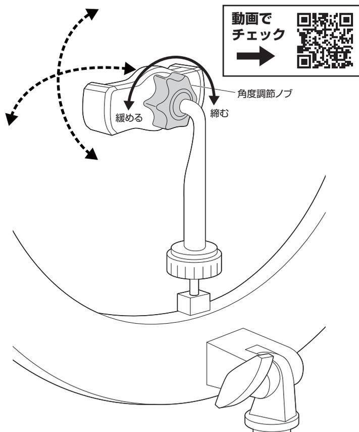
※調節後は、角度調節ノブをしっかり締め付けて固定してください。
