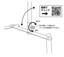
※調節後は、各調節ノブをしっかり締め付けて固定してください。
