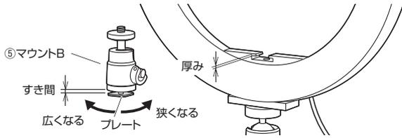
(2)マウントBのプレートをLEDライトに差込み、締め付けリングで締めます。
