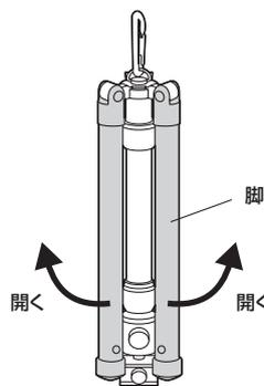
②スタンド本体をひっくり返し、脚が止まるまで戻します。ストッパーを矢印の方向へ引くと、脚の角度を変更できます。(3段階)
