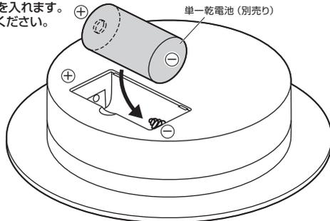
(3)電池カバーのツメを引っ掛けてから(C)方向にパチンと音がするまで押し込みます。
