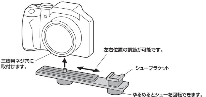
②ライト本体下部のプレートをシューブラケットのシューに差し込み、固定リングを回して固定します。※しっかり固定してから使用してください。
