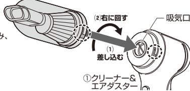
❸ **ダストボックスに用途に合わせて付属のノズルを取付けてください。**
