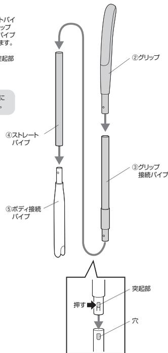
②ボディにボディ接続パイプを取付けます。
