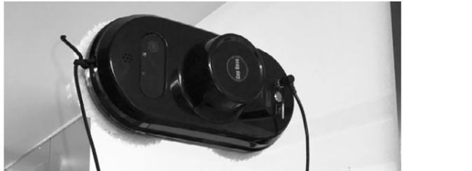
**注意** ※電源が供給されなくなった場合、赤色LEDが点滅して移動を止めます。
