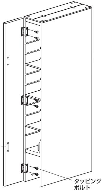
**8** 本体を起し、最上段の棚板を取付けて完成です。
