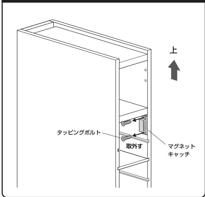
**5** 最上段の棚板を取外します。
