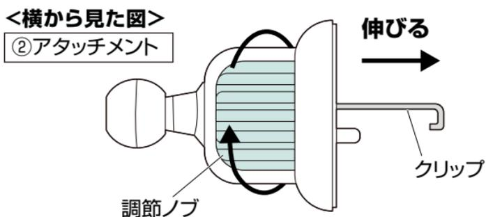
(2)エアコンの吹き出し口にクリップを差し込みます。
