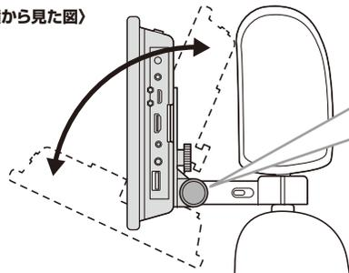
角度調節ノブを緩めてアタッチメントの角度を調節します。
