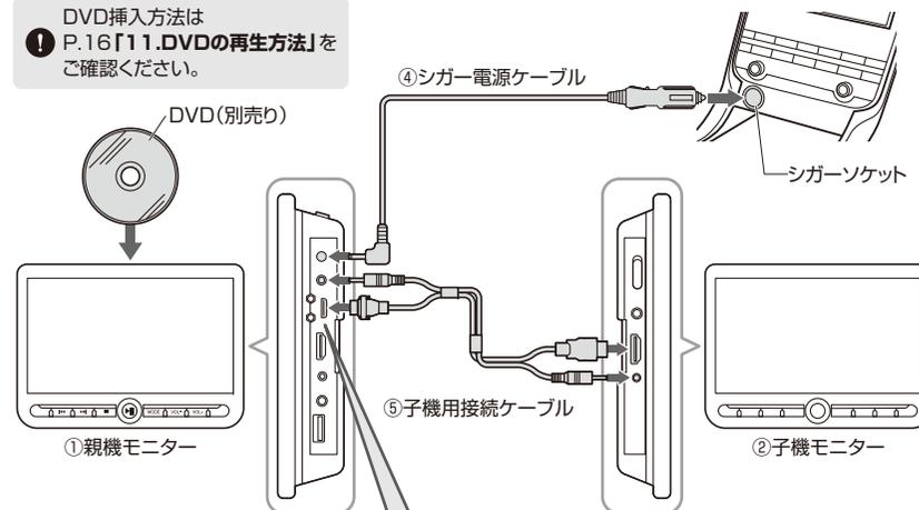
プラスドライバーを使用して、子機用接続ケーブルの固定ボルトを親機モニターの固定ボルト穴に取付けます。
