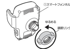
2.マウント、もしくはエアコン吹き出し口用アタッチメントに調整リング、スマートフォンホルダーの順に(A)、(B)、(C)と組み立てます。(A)、(B)は調整リングを回して固定します。(C)はエアコン吹き出し口用アタッチメントを組み立てます。
