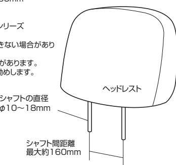
⚠ シャフト間隔が狭く取付けが難しい場合は、ヘッドレストをシートから取外して取付けてください。
