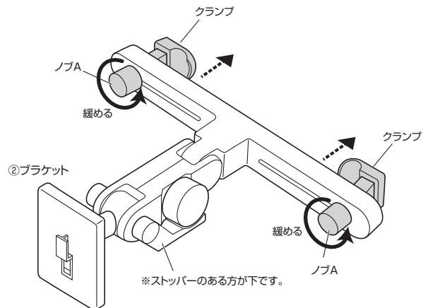
(2) クランプをシャフトの幅に合わせ取付けます。
