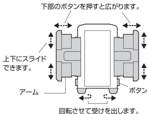
アームの幅・高さは取付ける機器に応じて自由に調節でき、様々な機器をホールドできます。
