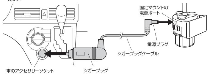
**警告** 本製品は12V車専用です。大型トラックなどの24V車では絶対に使用しないでください。
