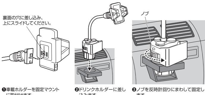
●車載ホルダーを固定マウントに取付けます。
