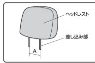
ヘッドレストの差し込み部について 差し込み部の直径:12mm以下 差し込み部のピッチ(A):90~180mm
