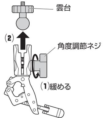
②雲台の取付け用ネジをカメラのネジ穴に取付けます。
