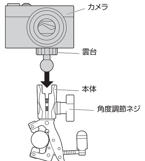
②カメラが被写体を向くように向きを調節し、角度調節ネジを締めます。
