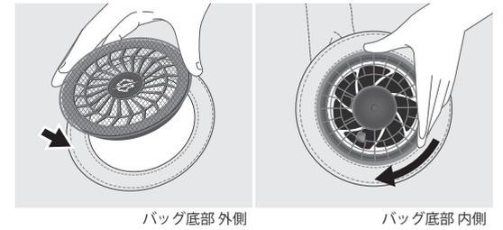
バッグ底部のファン取り付け口にネジ式カバーを外側から差し込みます。バッグの内側からファン本体をネジ式カバーへ取り付け、時計回りに回しながら固定します。
