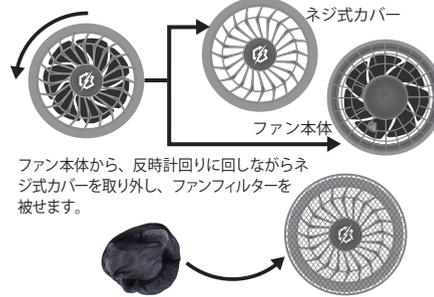
ファン本体から、反時計回りに回しながらネジ式カバーを取り外し、ファンフィルターを被せます。
