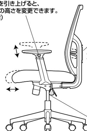
レバーを引き上げると、座面の位置を変更できます。(4段階)
