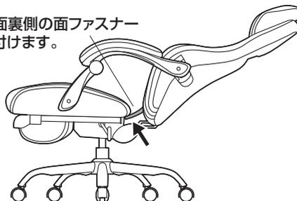
③再度座面に座り、肘あてを矢印の方向に動かして背もたれを起します。
