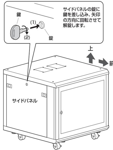
② 左右のロックを内側にスライドさせながらサイドパネルを矢印の方向に開いて取外します。
