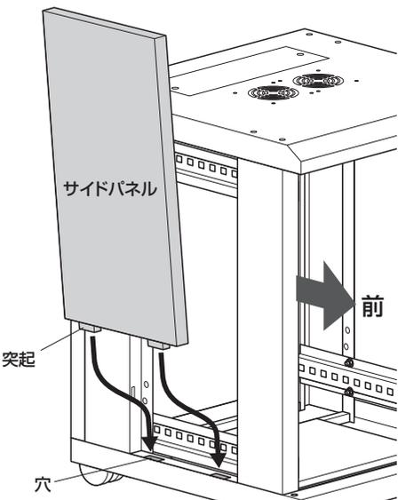
② サイドパネルを内側からタッピングボルトで固定します。
