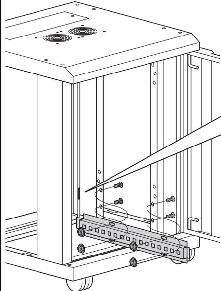
※ ブラケットの先端(長い方)をフレームのスリットに差し込み、ボルトで固定します。
