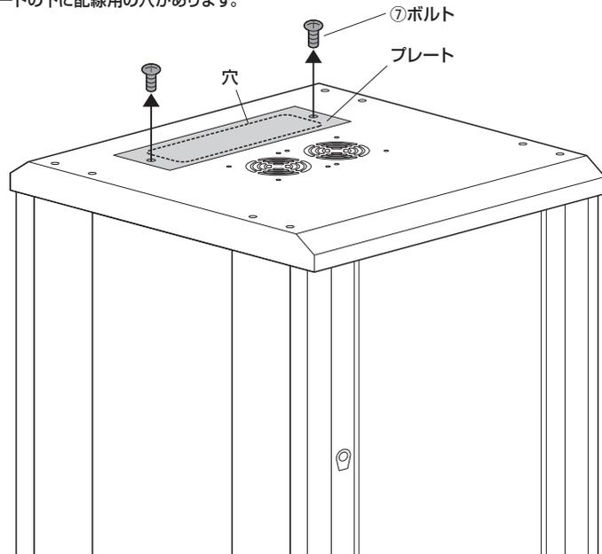
底板を取外し、大量のケーブルを引き込むことができます。
