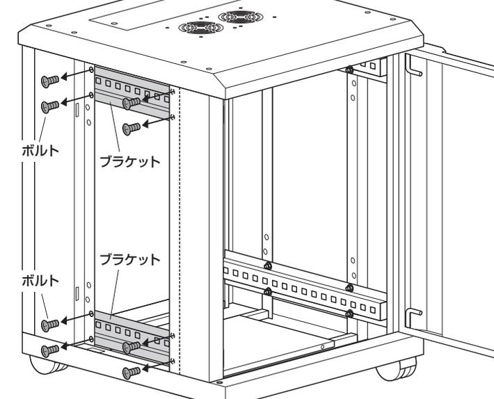
② ブラケットを後ろ側へスライドさせて取外します。
