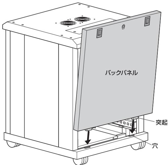
②バックパネルを「カチッ」と音が出るまで矢印の方向へ押し込みます。
