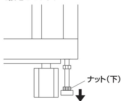
②上側のナットを回して本体に押し付け、アジャスターを固定します。
