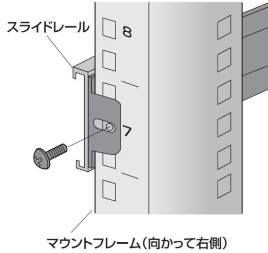
②後ろ側を取付けて固定します。
