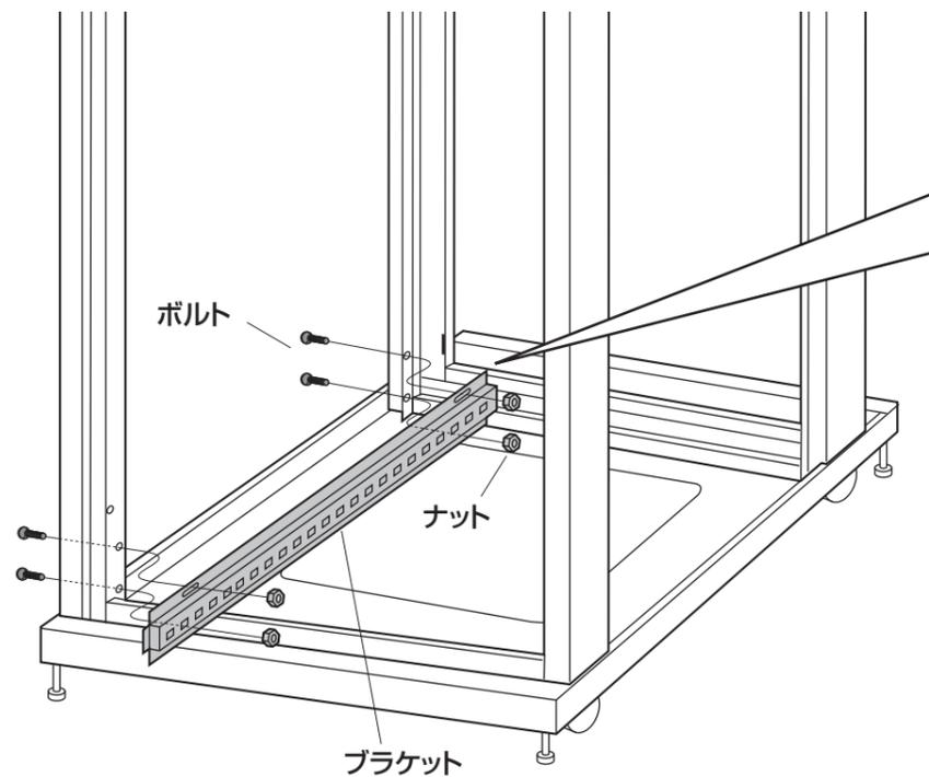
※ブラケットの先端(長い方)をフレームのスリットに差し込み、ボルトで固定します。
