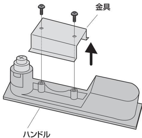
②扉の穴にハンドルを差し込み、再び金具を取付けて固定します。
