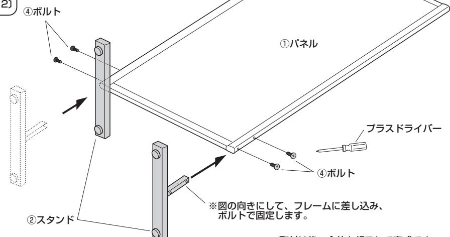
※図の向きにして、フレームに差しこみ、ボルトで固定します。
