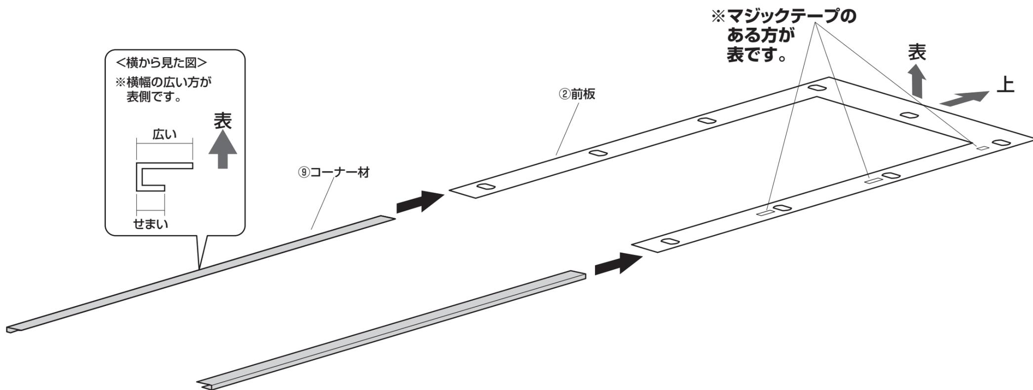
※コーナー材の先端が上側に揃うように差し込みます。
