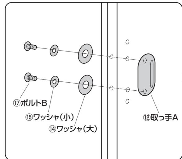
②ドア板の室外側に取っ手Bを取付けます。
