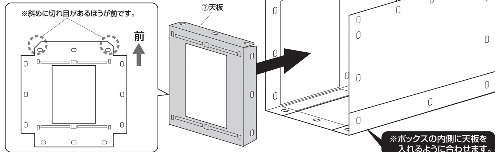
②ジョイント(大)で側面の6カ所(下図の位置のみ)を固定します。
