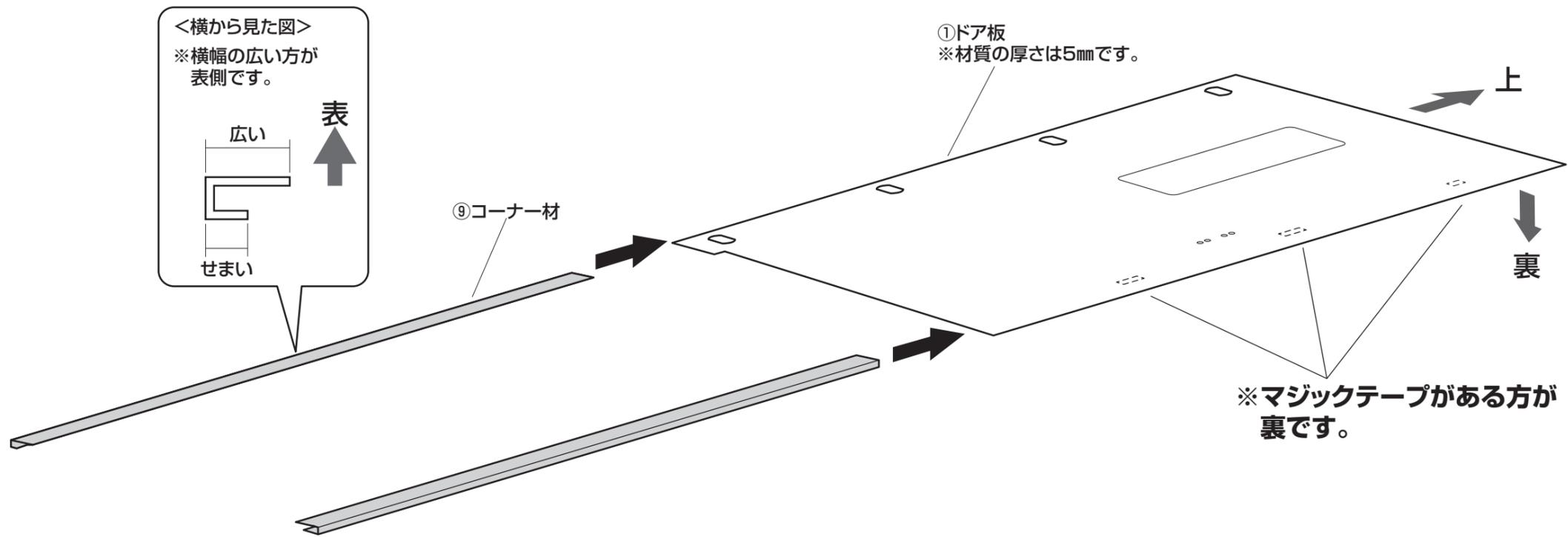
※コーナー材の先端が上側に揃うように差し込みます。
