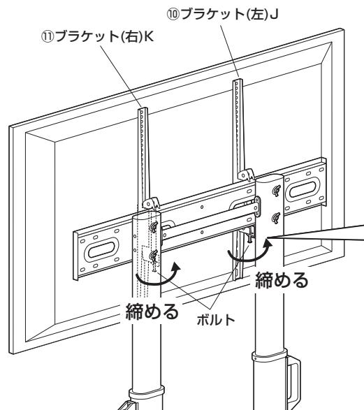
\*ボルトを締めて固定します。
