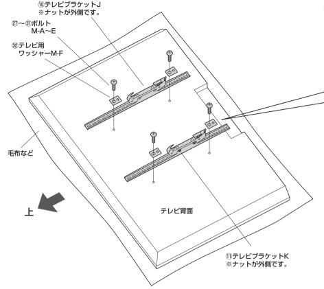
※付属のボルトが最後まで締まらない、 またボルトが少ししか回っていないなど、ボルトが合わない 場合は、強度に十分で注意の上、市販の適切なサイズのボルトをご用意ください。
